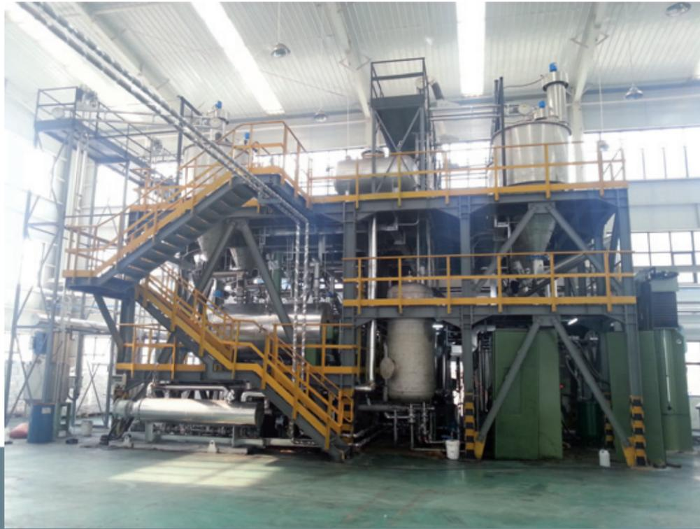
Impianto automatico per produzione sigillanti poliuretani alta viscosità con essiccamento polveri
