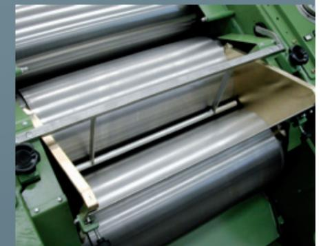
**TRE CILINDRI** sistema di sicurezza lato carico
