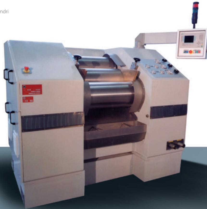
Le **RAFFINATRICI A TRE CILINDRI** sono tuttora il miglior sistema per la macinazione di diversi tipi di prodotti in pasta e ad elevata concentrazione, in particolar modo per quelli sensibili alla temperatura.
